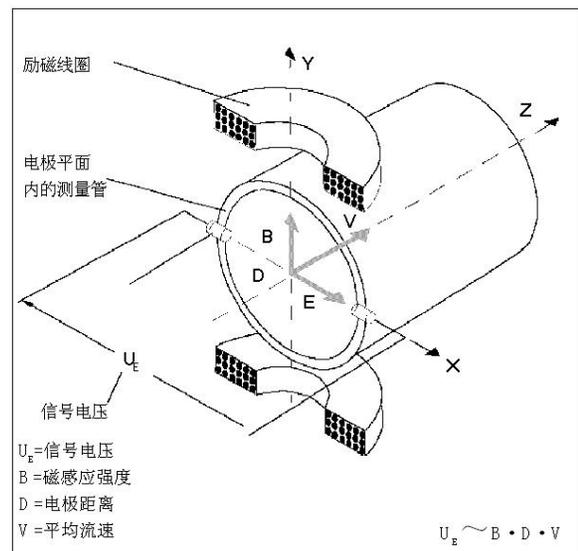
图2 电磁流量计原理图
