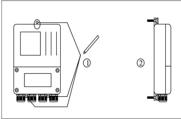
在墙上做好标记, 用冲击钻和膨胀螺丝将转换器固定在墙上。
